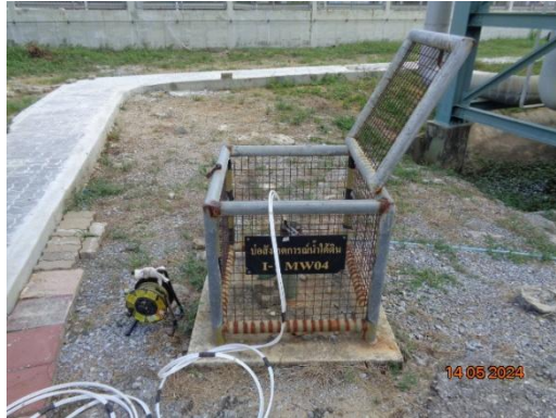
บ่อสังเกตการณ์น้ำใต้ดินต้นน้ำ บริเวณด้านทิศเหนือของโรงงาน GC2 (MW04)
