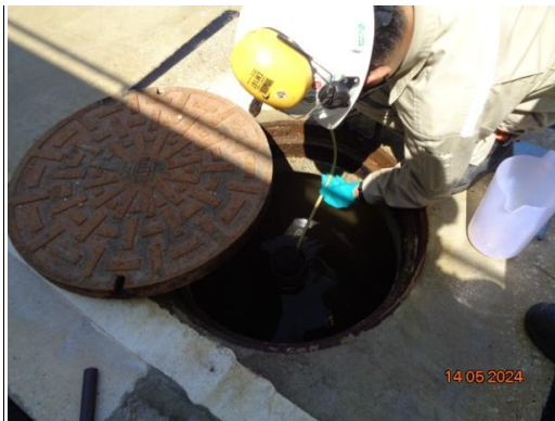
บ่อสังเกตการณ์น้ำใต้ดินท้ายน้ำ ของโครงการโรงผลิตสารโอเลฟินส์ โรงที่ 1/2 (MW02)
